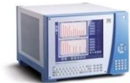
Kuva 2. Prosim C2 laaja-kaistainen radiokanava-simulaattori (kuva Elektrobit Oy)
